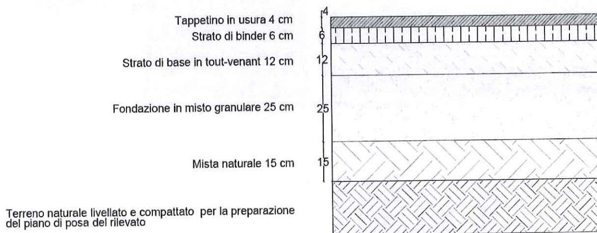
Figura 15 – Pacchetto pavimentazione stradale
