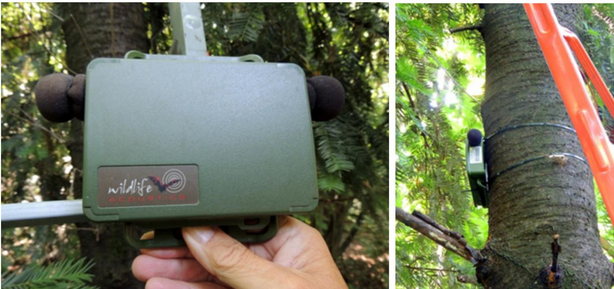
*Figg.11-12. Dettaglio ed installazione del registratore autonomo SongMeter.*
