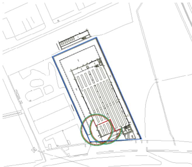
Fig.24 Aree di danno dello stabilimento Bisi logistica-scenario jet fire
