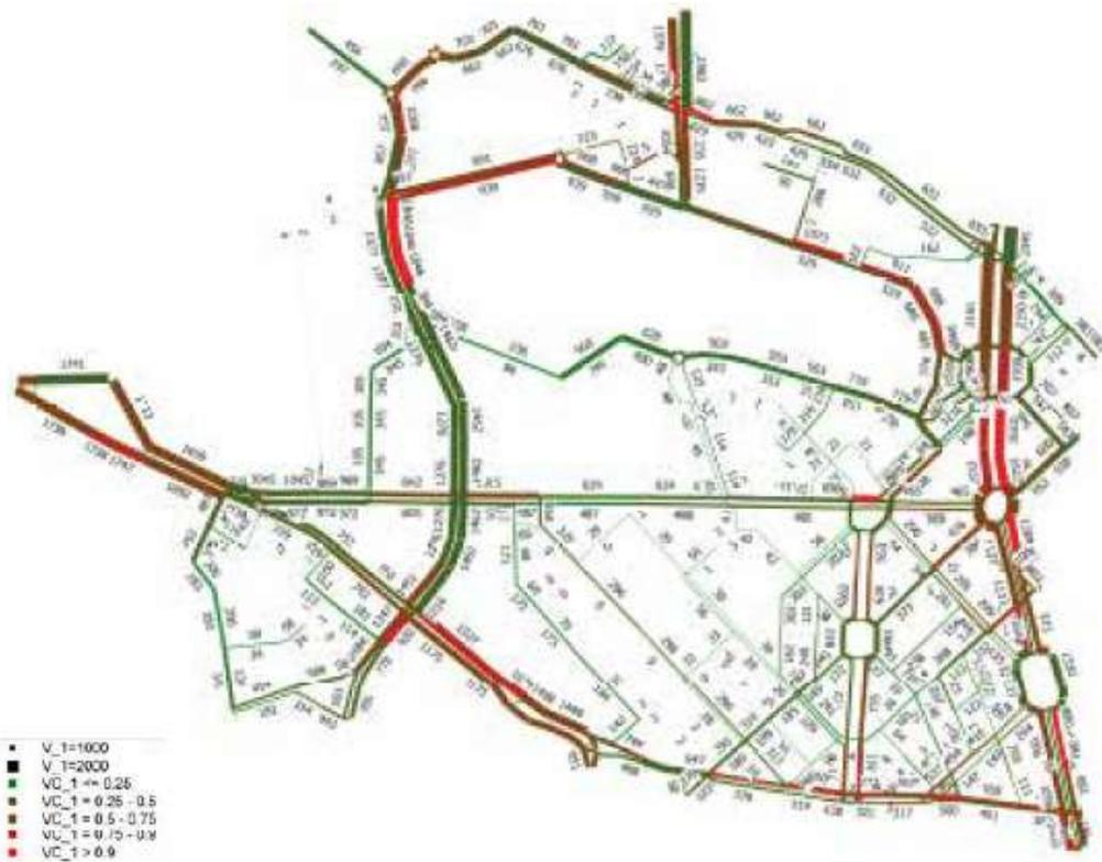
Figura 6-41 – Stato di riferimento ora di punta AM – Flussogrammi e V/C
