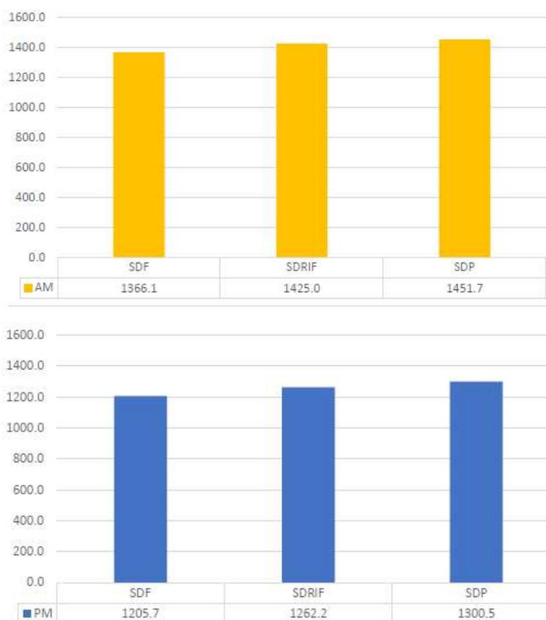
L'analisi delle velocità medie in rete (cfr. Figura 8-25) mostra quasi nessun cambiamento tra scenario dello stato di riferimento e quello di progetto, con una riduzione inferiore all'1%.
