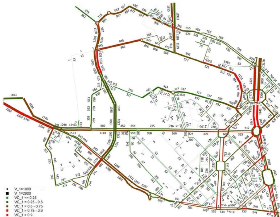
Figura 8-20 - Stato di progetto ora di punta PM – Flussogrammi e V/C
