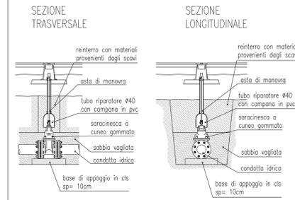
SCHEMA DI IDRANTE SOTTOSUOLO
