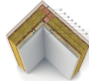
ISOLAMENTO IN LANA MINERALE SU STRUTTURA PREFABBRICATA
