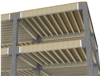
SOLAI MISTI CON TRAVETTI IN LEGNO LAMELLARE E CAPPA COLLABORANTE
