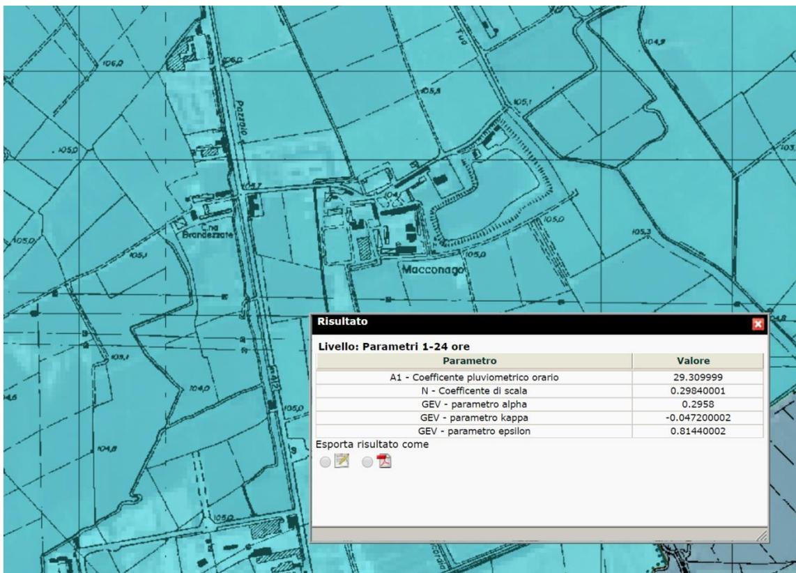
I parametri caratteristici delle curve di possibilità pluviometrica per la determinazione delle precipitazioni di progetto da assumere sono stati desunti da ARPA Lombardia (<http://idro.arpalombardia.it/pmapper-4.0/map.phtml>; cfr. figura : parametri 1-24 ore); essi sono i seguenti:
