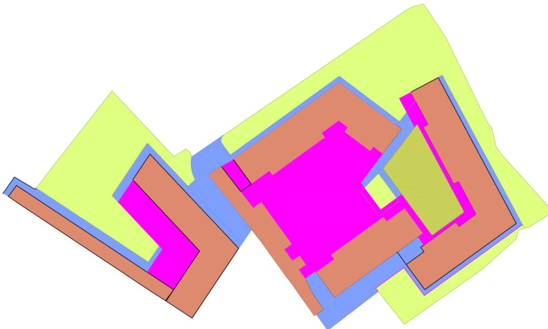
Il coefficiente medio ( $\varnothing_{med}$ ) per il bacino in esame risulta pari a **0,7180** mentre la Superficie impermeabile è pari a  $a_{S_{imp}} = 1,2900$  ha (12.900,68 m<sup>2</sup>).
