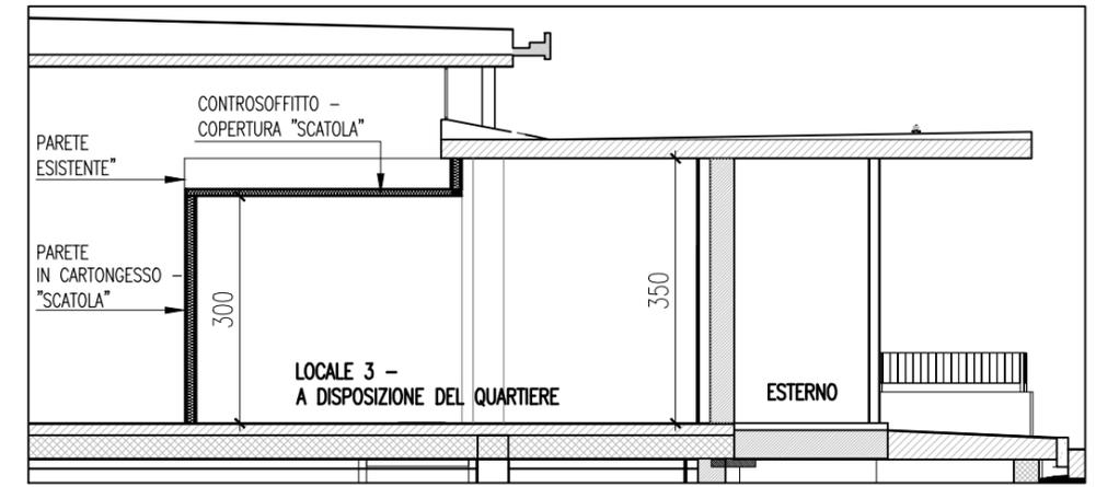
SCHEMA TIPOLOGICO - SEZIONE TRASVERSALE - "SCATOLE"
