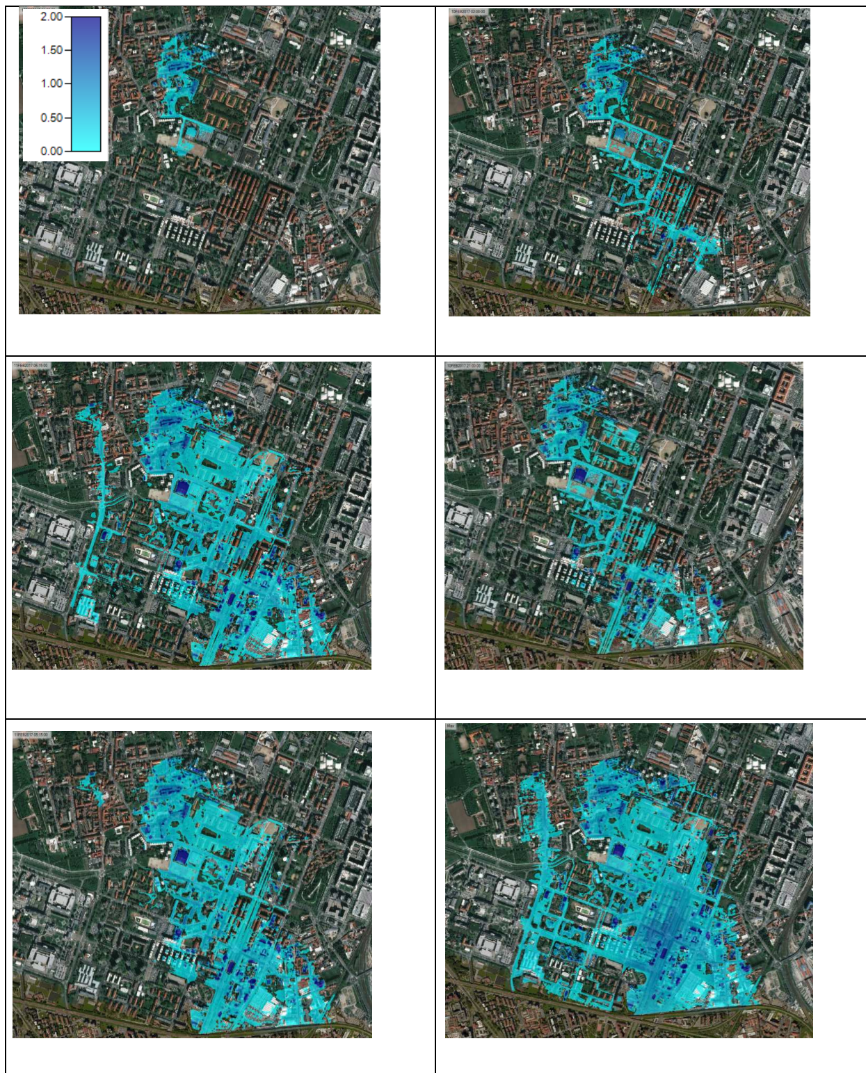
Figura 5.10 - Dinamica evolutiva dell'esondazione: l'ultima immagine in basso a destra rappresenta la configurazione con tiranti massimi (la legenda si intende riferita a tutte le immagini)
