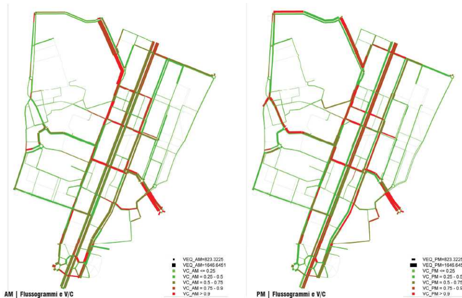
Figura 5.77 - Flussogrammi e rapporto V/C Progetto (AM e PM)
