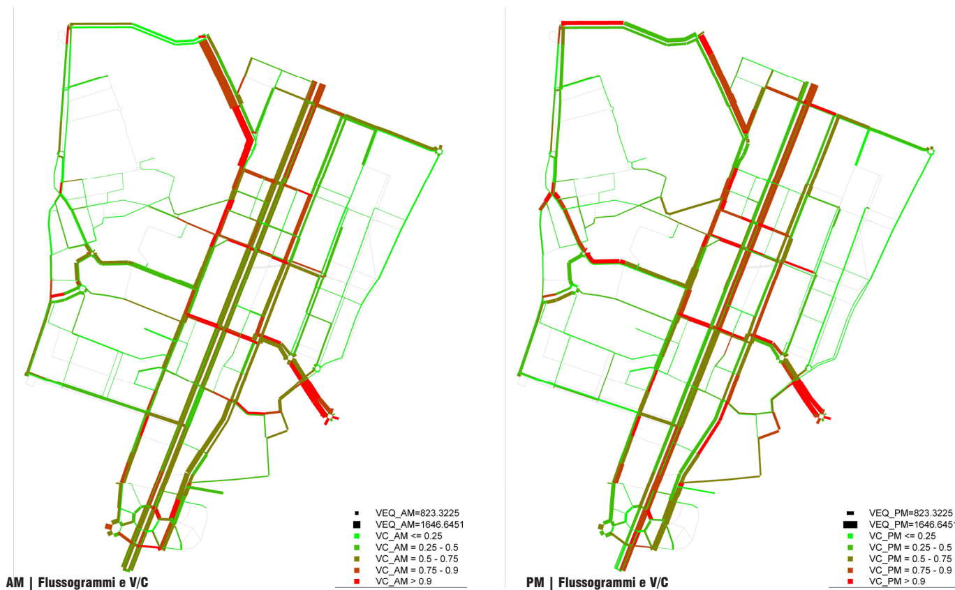
Figura 32: Flussogrammi e rapporto V/C Progetto
