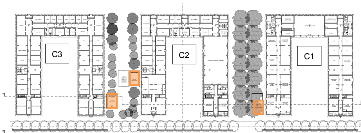
Figura 5.88 - Ubicazione dei gruppi frigoriferi all'interno della "Struttura pubblica di interesse generale"
