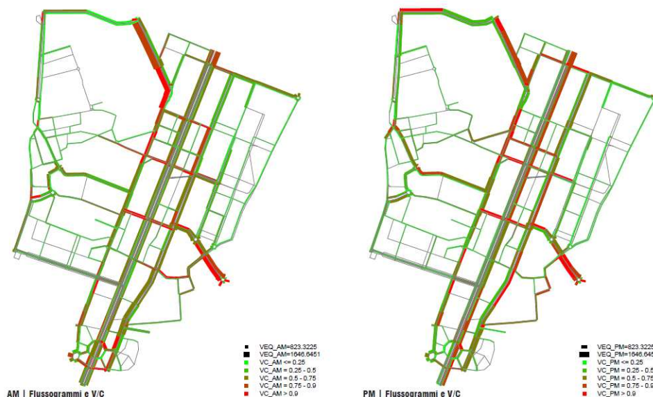
Figura 5.76 - Flussogrammi e rapporto V/C Reference (AM e PM)
