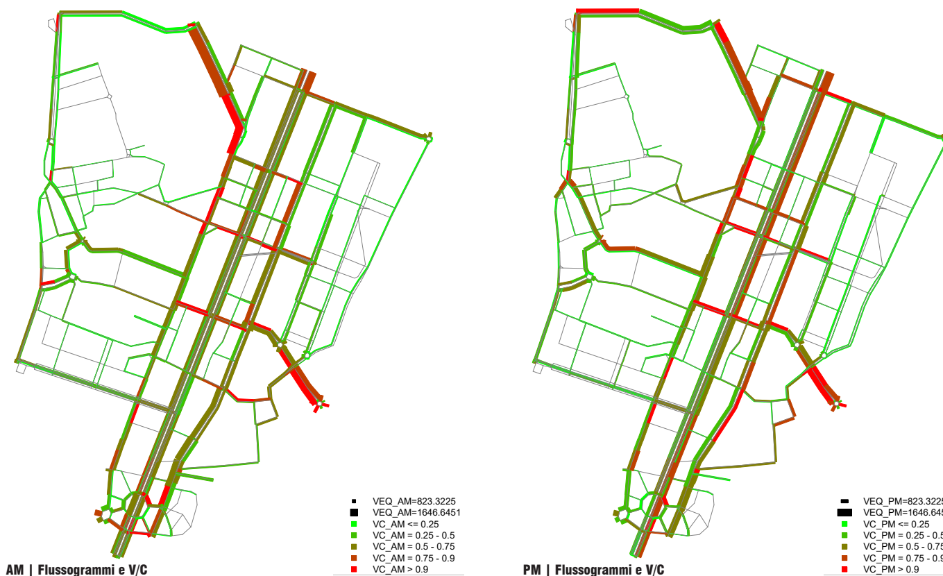
Figura 31: Flussogrammi e rapporto V/C Scenario di Reference
