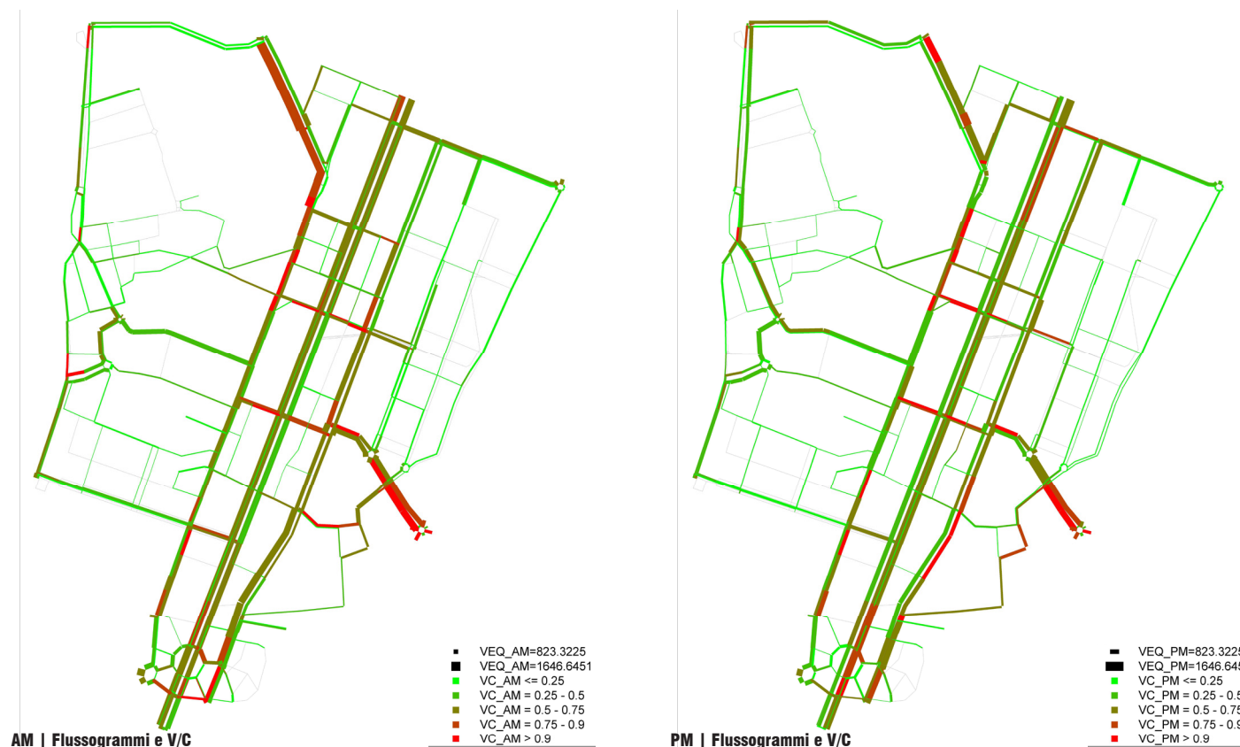
Figura 26: Flussogrammi e rapporto V/C Stato di Fatto
