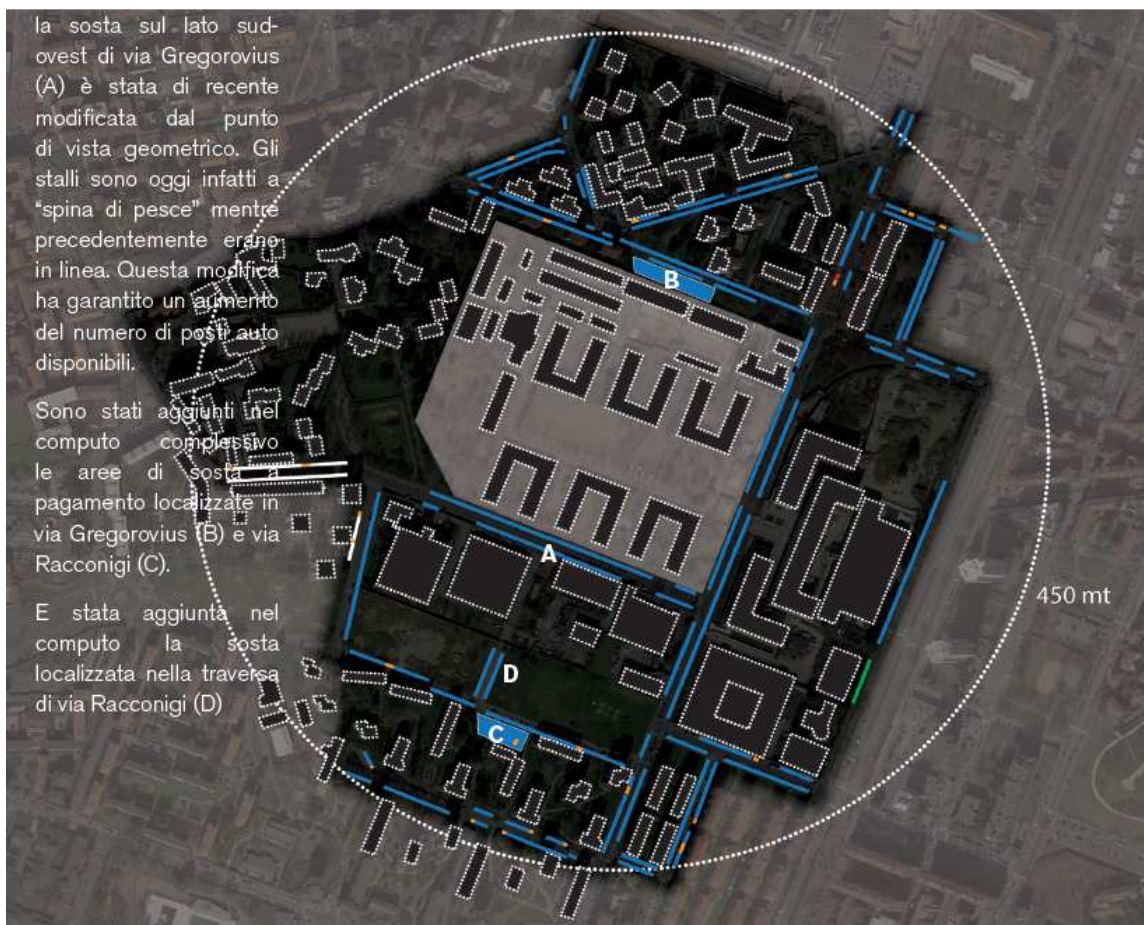
Figura 27: Rilievo dell'offerta di sosta in un'area di 450 mt dalla Caserma Mameli | Fonte MIC
