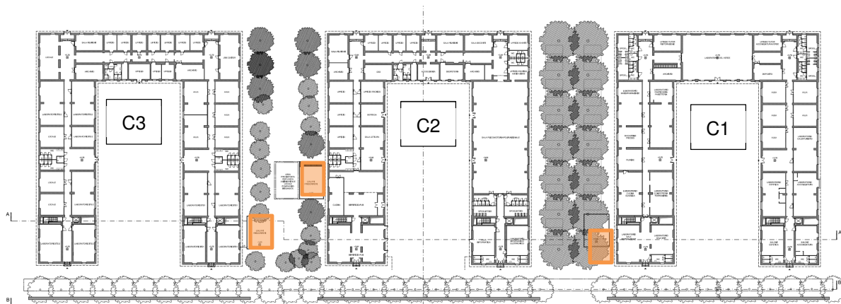
Figura 14: Ubicazione dei gruppi frigoriferi all'interno della "Struttura pubblica di interesse generale"
