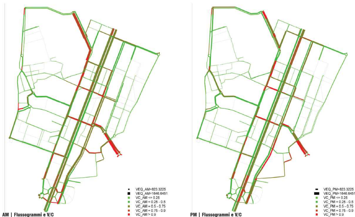
Figura 5.74 - Flussogrammi e rapporto V/C - Stato di Fatto (AM e PM)
