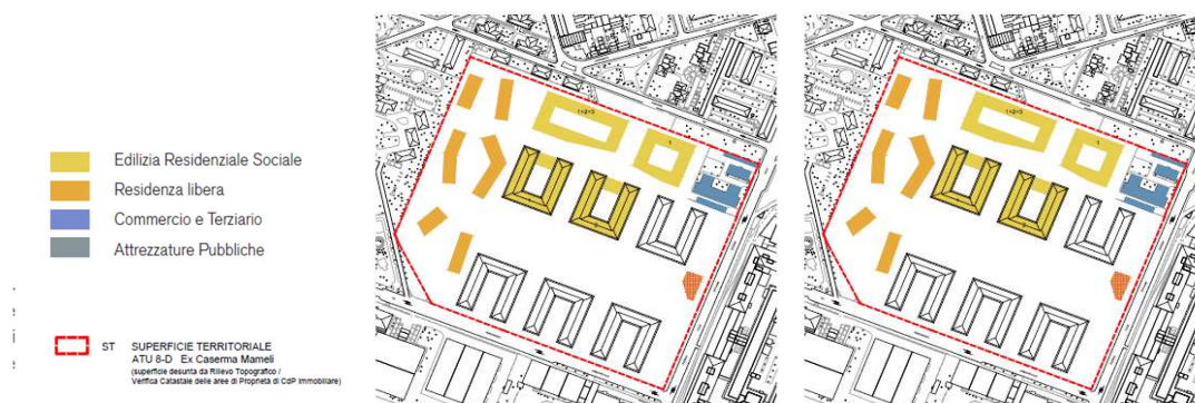
Figura 5.75 - Planimetria dello scenario di progetto (a sinistra piano terra, a destra piano tipo)
