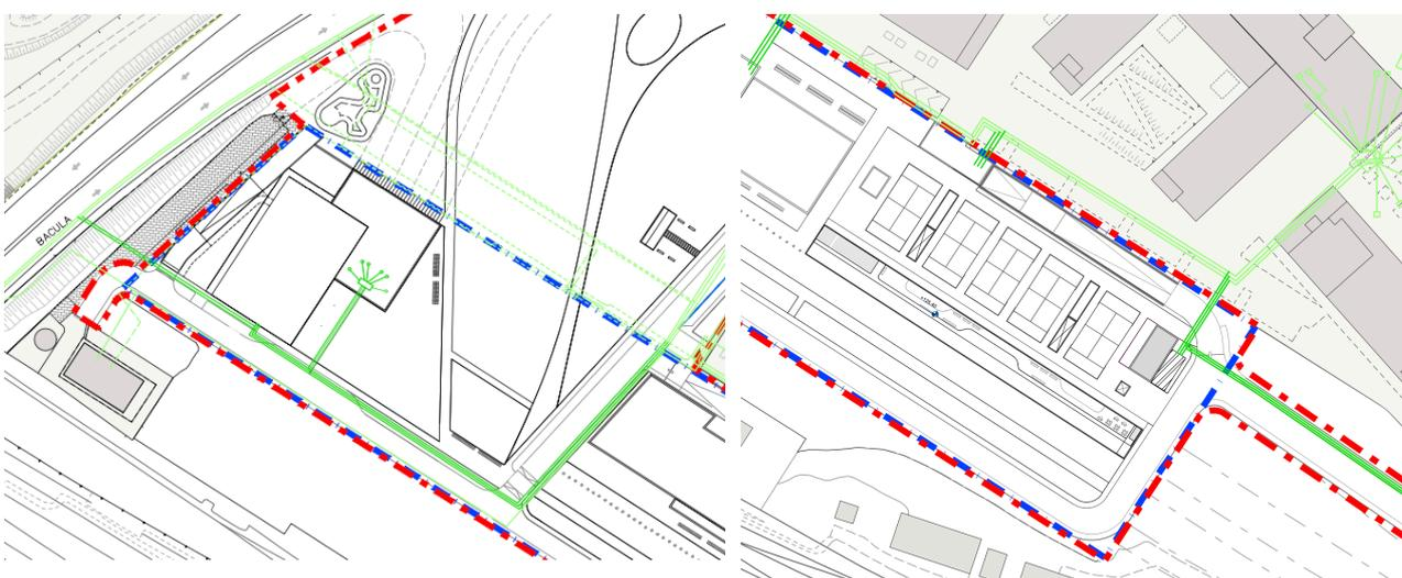
Figura 4 – Rete elettrica MT – Dettaglio allacciamenti e posizione cabina pubblica
