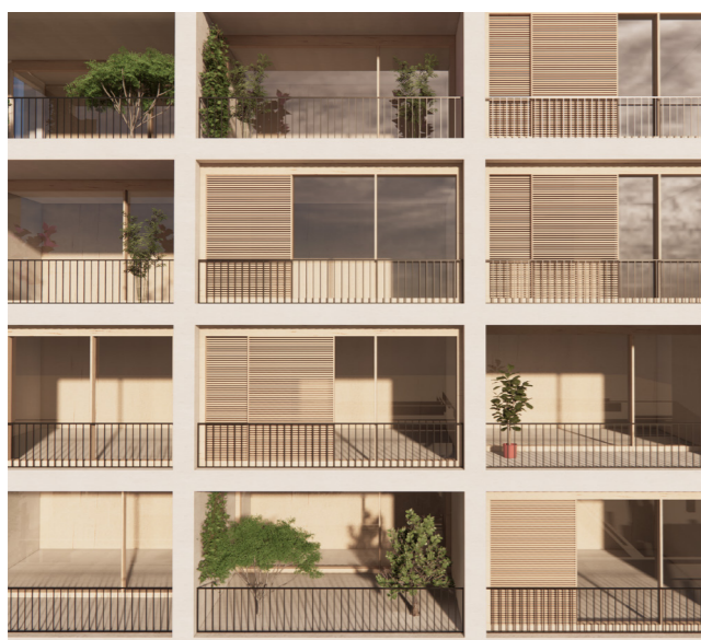
Tipologia di facciata con struttura in legno
