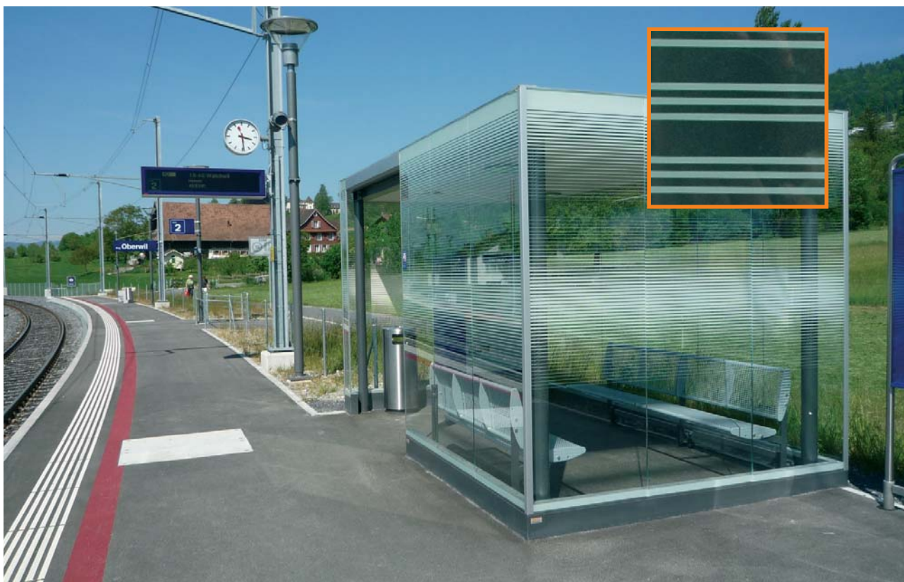
Nuovo standard per le pensiline delle ferrovie federali svizzere. Nella parte più bassa si è rinunciato alle marcature, ma la trasparenza viene alterata dalla sistemazione degli interni.
