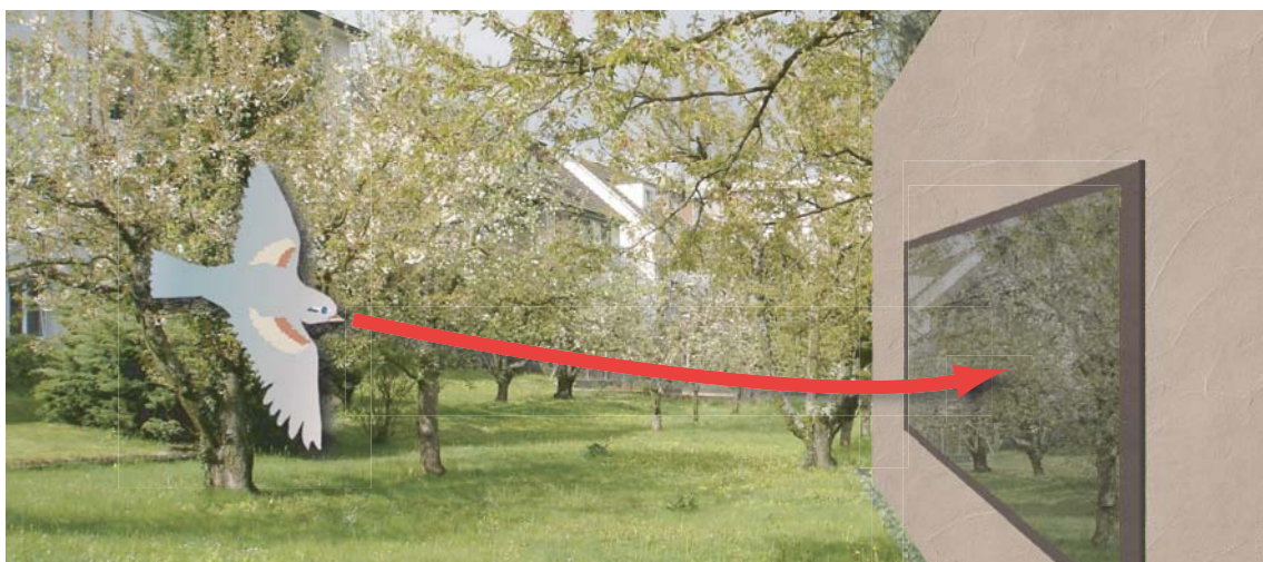
Vetri che filtrano la luce solare e molti altri tipi di vetro hanno un alto grado di riflessione: più i dintorni vi si riflettono e più sono naturali, più spesso si verificano collisioni.
