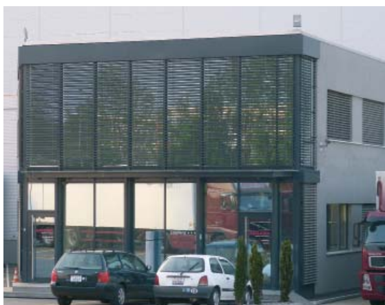
Vetri di protezione solare all'entrata di un edificio commerciale. La visiera del piano superiore riduce i riflessi.
